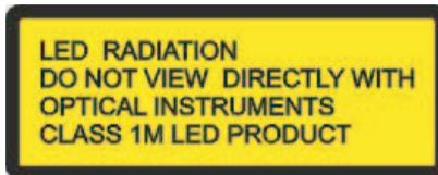
Dies entspricht Normen von IEC60825-1:1993+A11997+A2:2001 und die von EN 60825-1:1994+A1:2002+A2:2001
